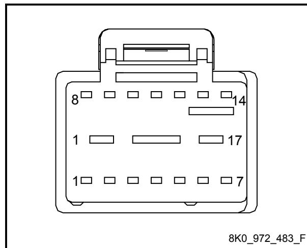
**插头连接 -T17ah-****插头连接 -T17f-**
